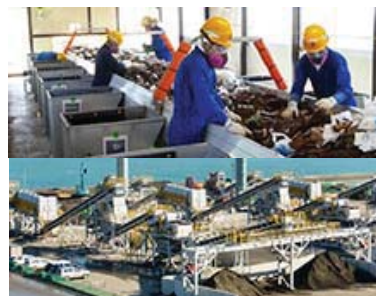
石巻市二次仮置場 （仮設破碎選別施設・手選別ライン）
