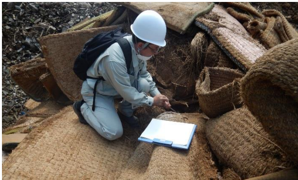
仮置廃棄物の内部温度計測状況
