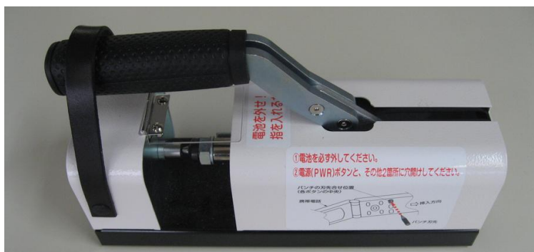
図 3-1-9 携帯電話の物理破壊（左：破壊工具、右：物理破壊後の携帯電話）
