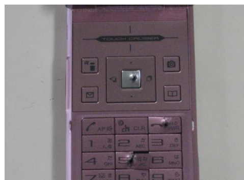
図 3-1-9 携帯電話の物理破壊（左：破壊工具、右：物理破壊後の携帯電話）
